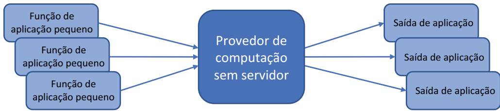
Figura 21.1 Em um ambiente de computação sem servidor, cada aplicação é dividida em unidades pequenas e discretas de componentes de aplicações. Cada componente é executado em um provedor de computação sem servidor, como os Aplicativos de Função do Azure, e é produzida uma saída que pode ser consumida por outros componentes da aplicação sem servidor ou outros serviços do Azure, como a IoT do Azure ou o Armazenamento do Azure.
