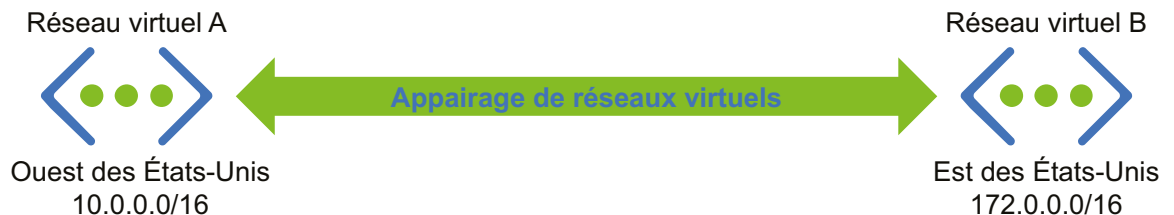
Figure 3.5 : connexion des ressources appartenant à différentes régions à l'aide d'un appariement de réseaux virtuels mondial
